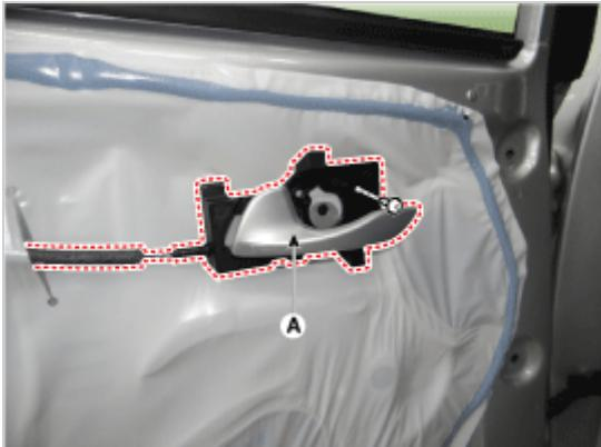
3. 拧下固定螺钉，并拆卸后车门装饰板固定支架(A)。
