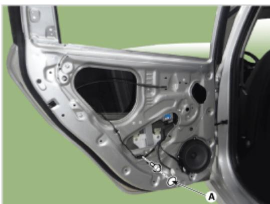
10. 小心调整后门窗玻璃(A), 直到看见螺栓为止, 并拧下固定螺栓。从玻璃滑道上分离玻璃, 并小心将玻璃从门窗开槽中拉出。
