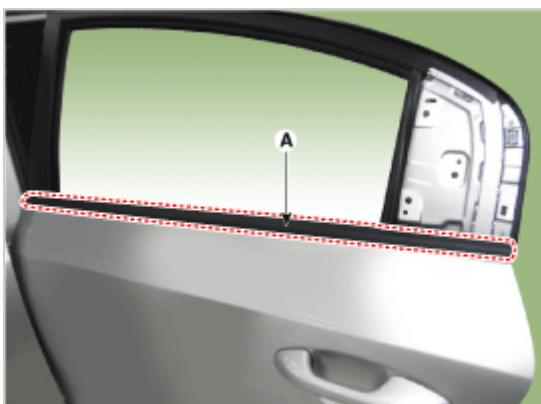
7. 拧下固定螺钉，并拆卸后车门三角装饰板 (A)。
