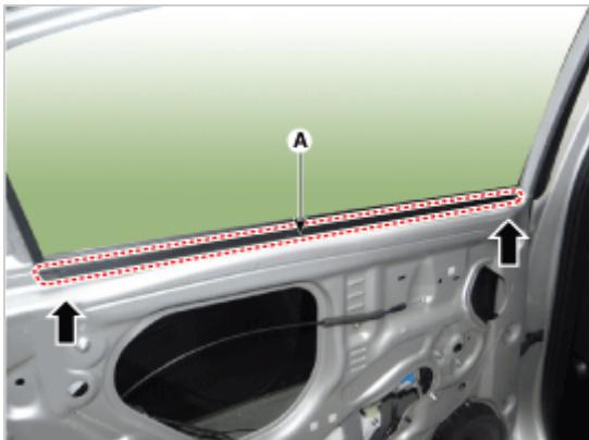
6. 拆卸后车门外侧带式密封条 (A)。
