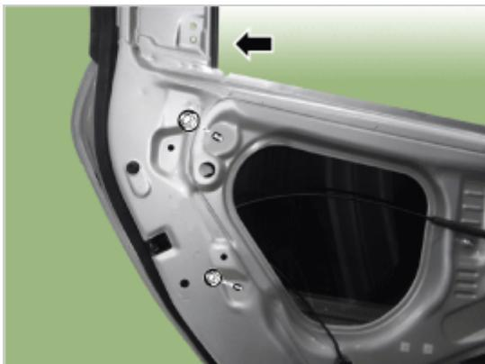
9. 拆卸后门窗玻璃固定孔塞(A)。
