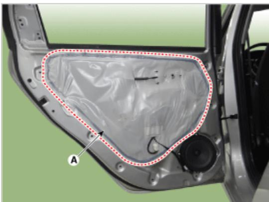
5. 拆卸后车门带式内侧密封条(A)。
